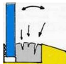
Рисунок 27. Неверно: 3 плоскости с разрывом
